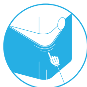
Optionaler Gewebevorfilter: Ein Gewebevorfilter fängt größere Partikel auf und erhöht die Nutzungsdauer des Hauptfilters.
